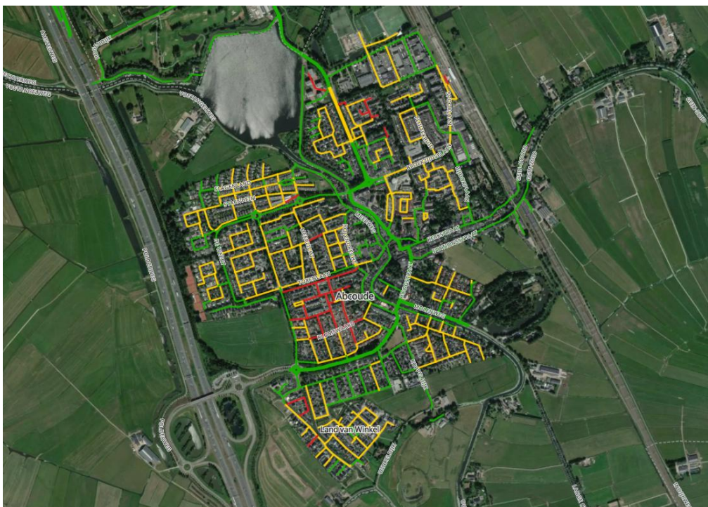
Figuur 4 Uitsnede uit stresstest wateroverlast bij een bui van 90 mm in één uur in Abcoude
